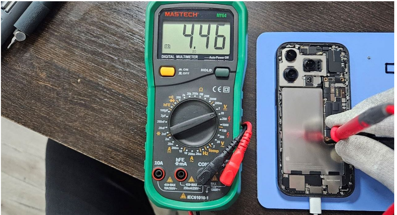
Фото 5. Замер напряжения аккумуляторной батареи.
